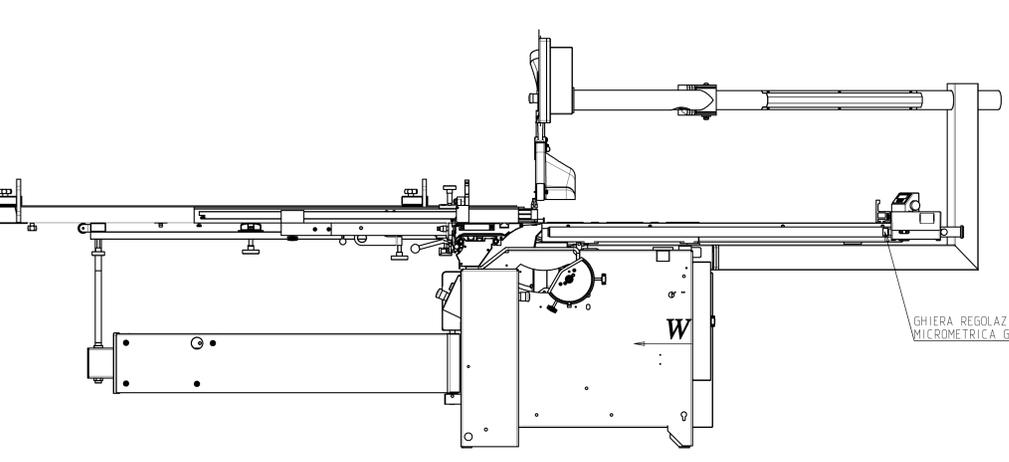
GHIERA REGOLAZIONE MICROMETRICA GUIDA PARALLELA
